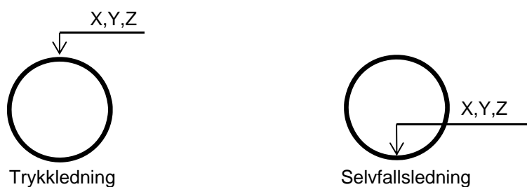
Figur 1. Måling av ledningshøyde.
