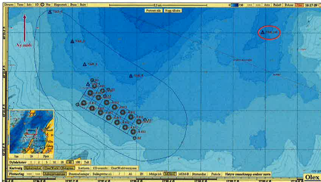
Figur 2: Referansestasjon, markert med rød sirkel, etablert 1400m fra anleggsrammen for fremtidig sammenligning. Kartet har nordlig orientering
