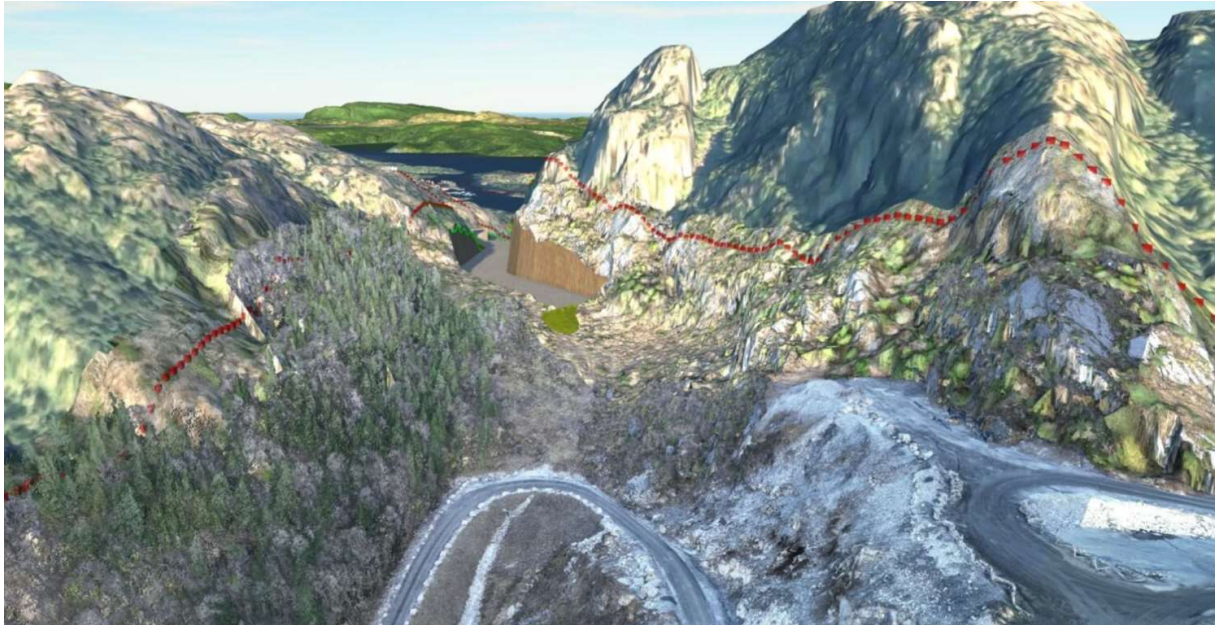
Figur 3-9 Søndre del av transportvei mot Remskardet i regulert løsning. Nærmest i bildet vises areal ved knuseverk og adkomstvei til kai på Remman. Bilderetning fra sør mot nord. Røde linjer er plangrense for gjeldende plan, grønn linje er formålsgrense i gjeldende plan.
